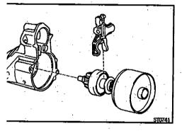
7. REMOVE DRIVE LEVER AND STARTER CLUTCH WITH SHOCK ABSORBER FROM STARTER HOUSING
