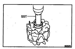
(d) Using SST and a press, press in a new bearing. SST 09820-00030
